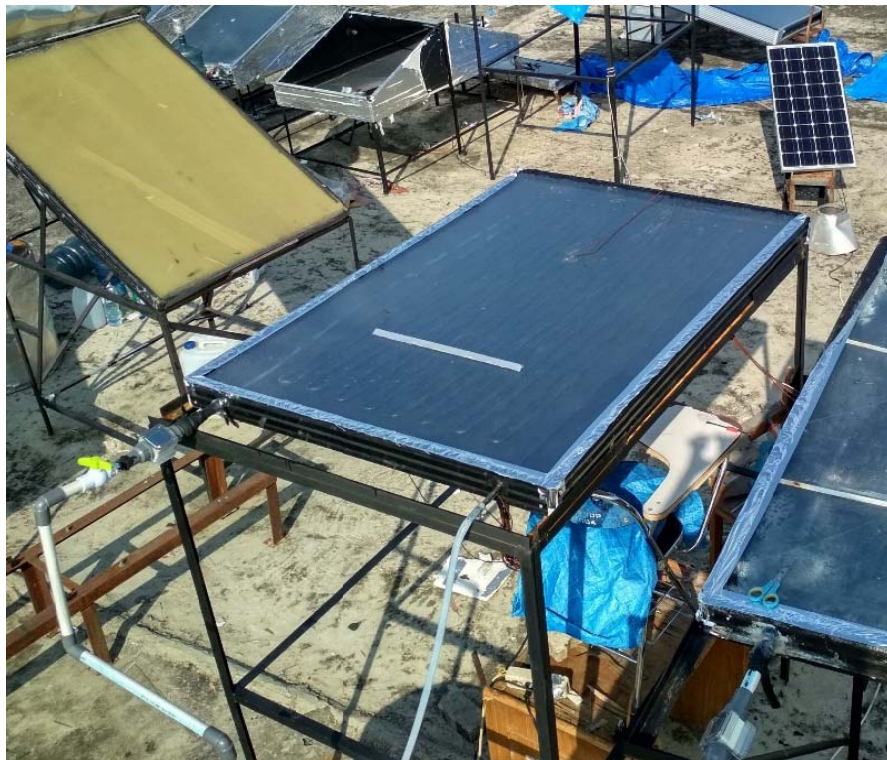
Gambar 2. Instalasi pengujian kolektor surya dengan penambahan sirip
