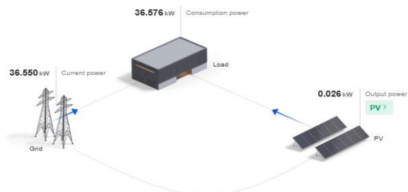
Gambar 7. Aliran Daya jika Zero Export berjalan pada Fusion Solar Sumber: Data olahan
