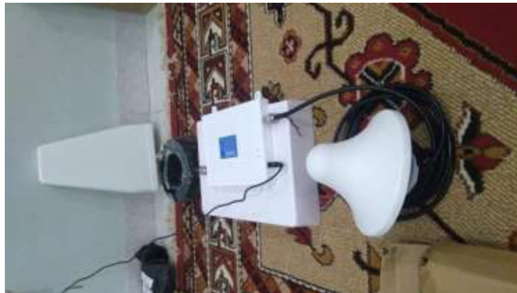
Gambar 3. Teknologi Penguat Sinyal GSM yang Digunakan
