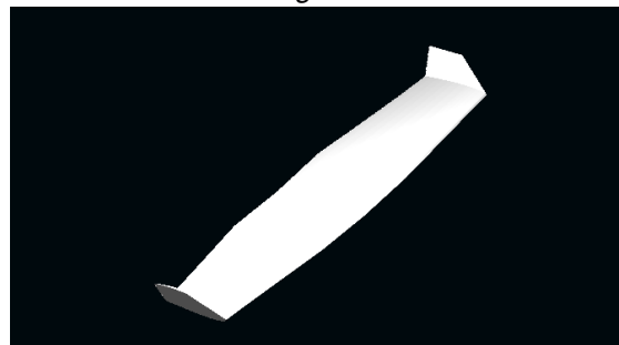
Gambar 5. Sayap Cessna 172R dengan cant angle 60°
