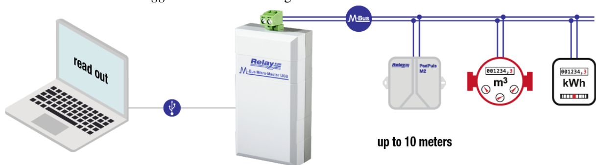
Gambar 3. Skematik Diagram Sistem M-Bus Data Logger
