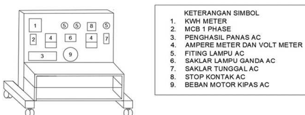
Gambar 3. Desain Perangkat Digital Adjustable Voltage Current Protector Sumber: Penulis (2025)
