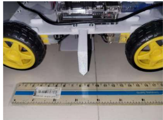
Gambar 6. Pointer menunjuk posisi robot berhenti pada 8,5 cm.
