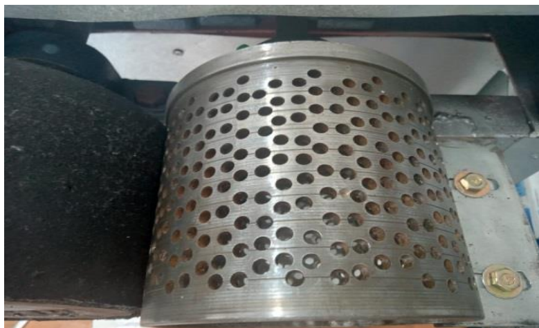
Gambar 2. Tabung penggiling desain modifikasi baru
