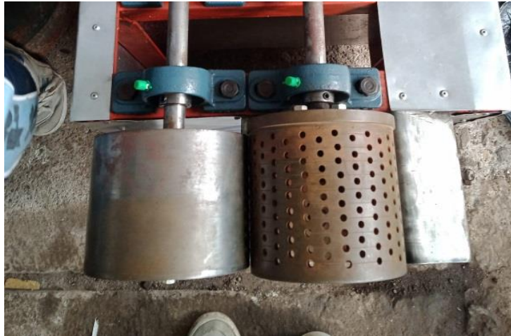
Gambar 1. Tabung penggiling desain lama sebelum di modifikasi
