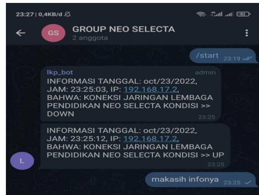
Gambar 24. Tahap Testing Notifikasi Konektifitas Ke Group Telegram
