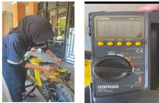
Gambar 8 . Pengukuran Lampu Sein
