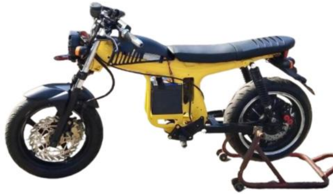
Gambar 1. Motor Listrik Hasil Konversi
