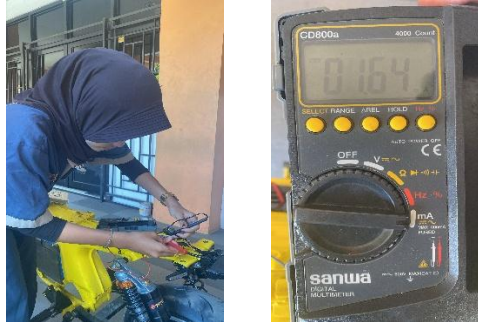
Gambar 7 . Pengukuran Lampu Rem
