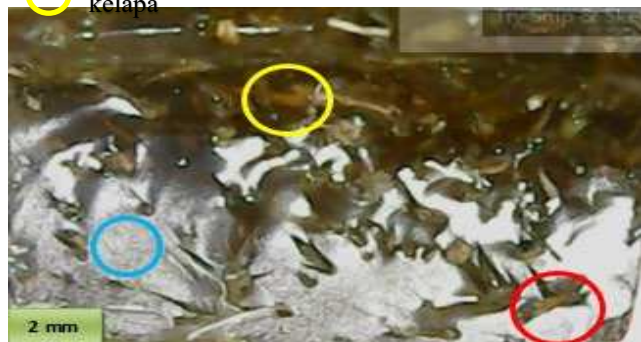
Gambar 12. Patahan spesimen bending variasi serat 50 : 50
