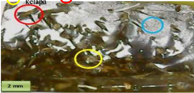
Gambar 10. Patahan spesimen tarik variasi serat 50:50
