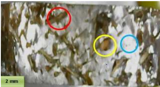
Gambar 9. Patahan spesimen tarik variasi serat 30 : 70.
