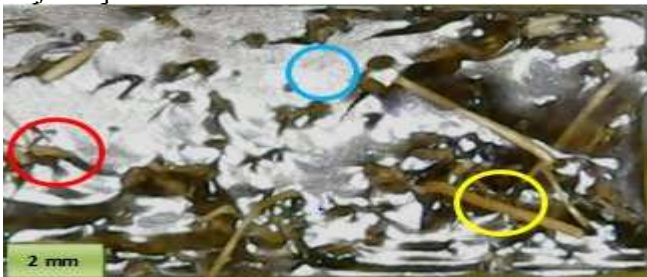
Gambar 11. Patahan spesimen bending variasi serat 20 : 80
