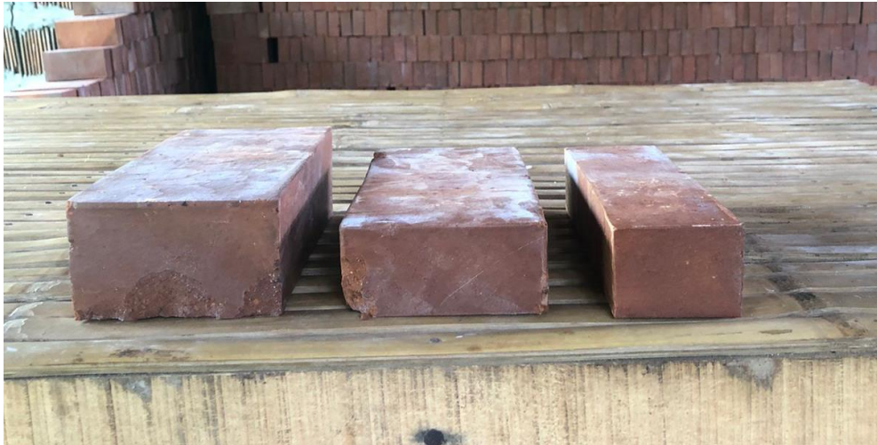
Gambar 1. Produk bata press produksi UD. Intan Dari kanan ke kiri: bata tipis panjang, bata tipis dan bata tebal, Sumber : Dokumentasi Pribadi
