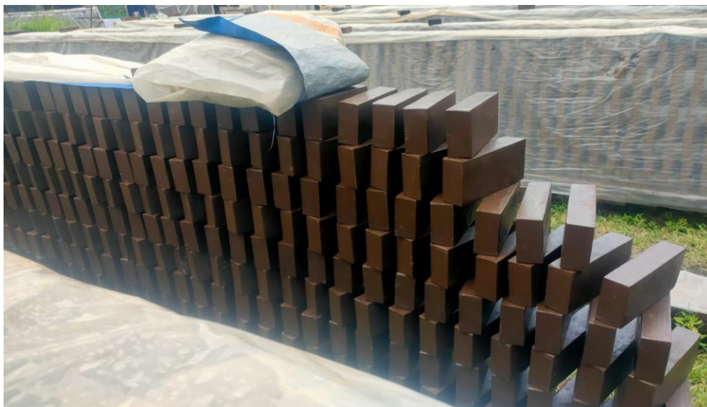
Gambar 2 . Produk bata press produksi UD. Intan Proses Penjemuran, Sumber : Dokumentasi Pribadi
