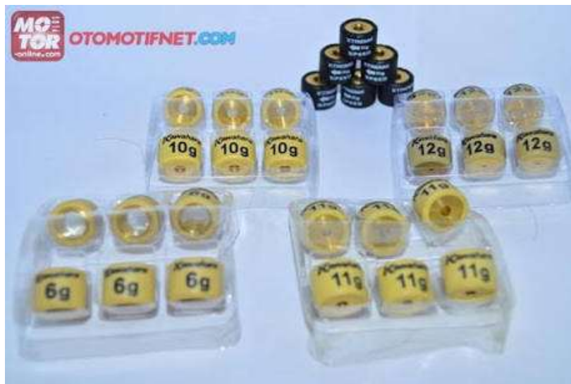
Gambar. 2 Macam roller pada transmisi otomatis
