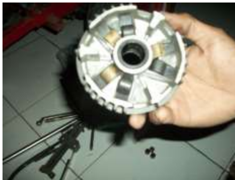
Gambar. 4 Pemasangan kombinasi roller 9 dan 11 gram
