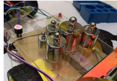
Gambar 8 Pengujian Akurasi sensor loadcell
