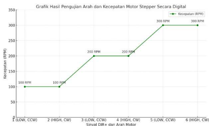
Gambar 4.3 Grafik Pengaturan Arah Putaran Motor Stepper NEMA23 Dengan Sistem Digital
