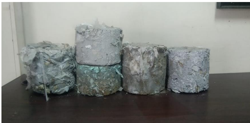
Gambar 4 Hasil Pencetakan sampah blok dengan mesin pencetak sampah blok sistem hidrolik
