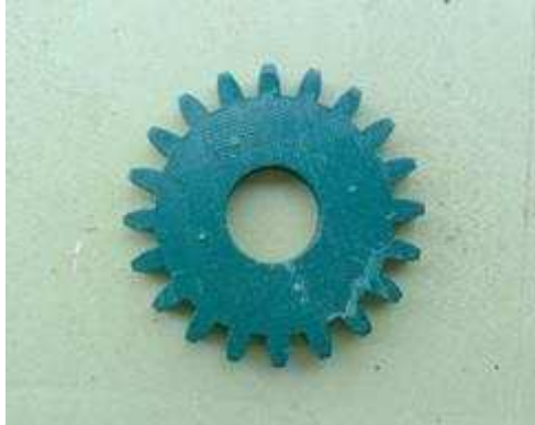
Gambar 3. Hasil 3D print pola pengecoran roda gigi lurus
