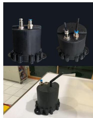
Gambar 11. Hasil Assembly Perangkat Keras Data Logger
