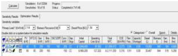
Gambar 13. Konfigurasi optimum sistem PLTH hasil optimasi HOMER
