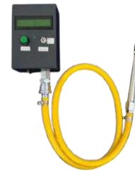
Gambar 13. Alat Pendeteksi Tekanan Udara Ban Bus Berbasis IoT
