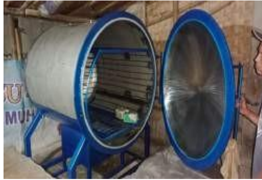
Gambar 5. Autoclave (alat sterilisasi baglog)
