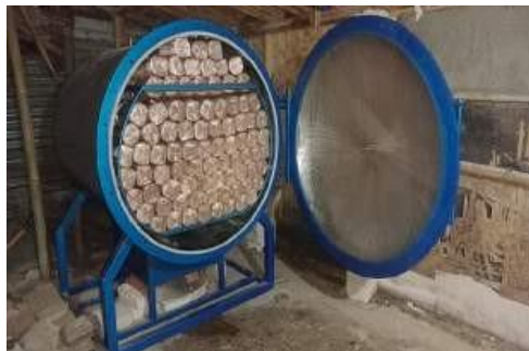
Gambar 6. Penyusunan Baglog di Autoclave yang Siap di Sterilisasi
