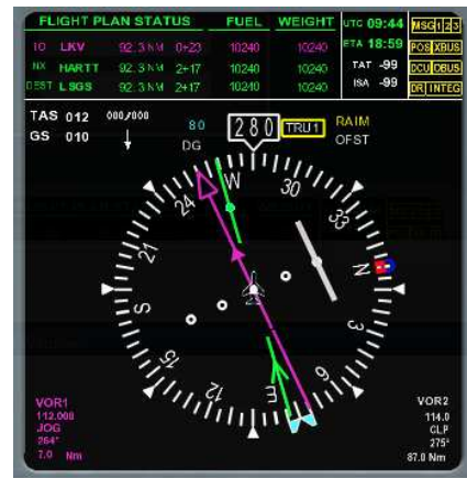
Gambar 16 B. Instrumen HSI Simulator VOR JOG
